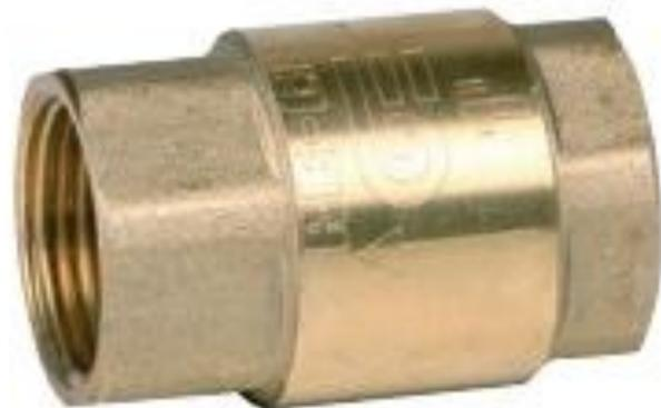
Válvula de retención en latón con clapeta de latón, monobloque desmontable. Muelle en INOX 316. Cumple con la Norma UNE EN 1717 – Categoría EB, anticontaminación NO controlable. Apta para instalaciones neumáticas, industriales e hidráulicas.
